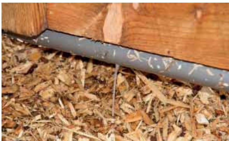
Die Funktionsweise ist relativ einfach. Die Molke wird über eine Kunststoffleitung in einen Ausgleichsbehälter im Zentrum des „Molkereaktors“ geleitet und von dort über 12 Tropfleitungen über die Hackschnitzel verteilt. Pro Tag fallen ca. 3000 Liter Molke an. Für
